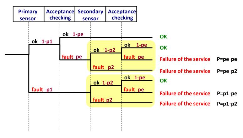
Failure of the service at system level:  $pe \cdot pe + pe \cdot p2 + p1 \cdot pe + p1 \cdot p2$
